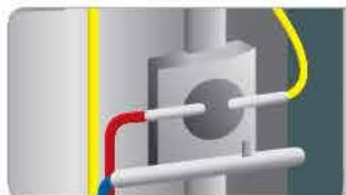
**2. HỆ THỐNG KIỂM SOÁT NHIỆT TRS** (Thermal Reed Switch) giúp kiểm soát nhiệt độ luôn ở mức 70-76°C, làm cho cơm luôn dẻo và đúm trong suốt thời gian giữ ấm.
