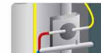
2. HỆ THỐNG KIỂM SOÁT NHIỆT TRS (Thermal Reed Switch) giúp kiểm soát nhiệt độ luôn ở mức 70-760C, làm cho cơm luôn đều và dù ẩm trong suốt thời gian giữ ấm.
