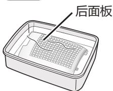
1. 在水中滴几滴厨房用洗涤剂，将后面板浸泡 10 分钟左右。
