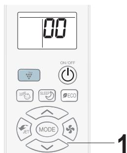
**2** Án nút THERMOSTAT “ ” và “ ”, màn hình điều khiển từ xa sẽ lần lượt chuyển từ “ 00 ” sang “ 2 / ”. Đồng thời, còi báo sẽ phát ra tiếng bip ngắn ở mỗi bước.
