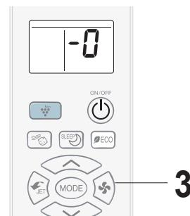
**4** Án nút THERMOSTAT “ ” và “ ”, màn hình điều khiển từ xa sẽ lần lượt chuyển từ “ -0 ” sang “ -1 ”. Đồng thời, còi báo sẽ phát ra tiếng bip ngắn ở mỗi bước.
